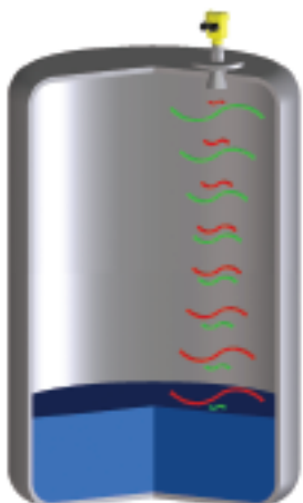
Berøringsløs radar nivåmåling for væsker og faststoff takler krevende oppgaver og prosessforhold i enhver industri.
